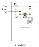
V : Varistor Ft : Fusible térmico LED : Indicador de desconexión t° : Sistema de desconexión térmica
