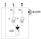
V : Varistance GSG : Eclateur spécifique Ft : Fusible thermique Buzzer : Indicateur de déconnexion sonore t° : Système de déconnexion thermique
