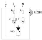
V : Varistor GSG : Descargador specifico Ft : Fusible térmico Buzzer : Indicador de desconexión audible t° : Sistema de desconexión térmica
