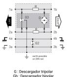
G : Descargador tripolar Gb : Descargador bipolar R : Resistor D : Diodo limitador
