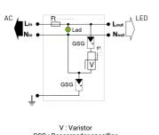
V : Varistor GSG : Descargador specifico LED : Indicador de desconexión F : Fusible térmico t° : Sistema de de desconexión térmica
