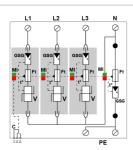
V : Varistance haute énergie GSG : Eclateur spécifique Ft : Fusible thermique C : Contact de télésignalisation t° : Système de déconnexion thermique MI : Indicateur de déconnexion
