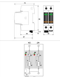
V : Varistor de alta energía Ft : Fusible térmico C : Contacto de teleseñalización t° : Sistema de desconexión térmica MI : Indicador de desconexión
