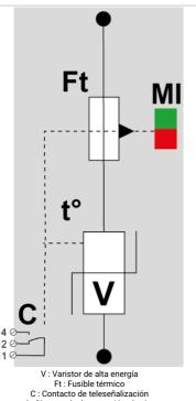
C : Contacto de teleseñalización t° : Sistema de desconexión térmica MI : Indicador de desconexión
