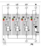
V : Varistor de alta energía GSG : Descargador specífico F1 : Fusible térmico C : Contacto de téléseñalización t° : Sistema de desconexión térmica MI : Indicador de desconexión
