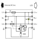
G : Eclateur à Gaz 2 pôles G3 : Eclateur à Gaz 3 pôles D : Diode d'écrêtage V : Varistance LED : indicateur Ft : Fusible thermique
