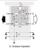
G: Eclateur tripolaire Gb: Eclateur bipolaire PTC: Résistance thermique R: Résistance D: Réseau de diode d'écrêtage Vi: Indicateur
