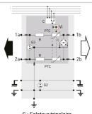
G : Eclateur tripolaire Gb : Eclateur bipolaire PTC : Résistance thermique R : Résistance D : Réseau de diode d'écrêtage Vi : Indicateur
