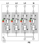
V : Varistor de alta energía Ft : Fusible térmico F : Protección contra la sobretensión (fusible) t° : Sistema de desconexión térmica C : Contacto de teleseñalización MI : Indicador de desconexión
