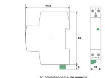
V : Varistance haute énergie GSG : Eclateur spécifique LED : Indicateur de déconnexion Ft : Fusible thermique t° : Système de déconnexion thermique C : Contact de télésignalisation
