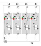
V : Varistance haute énergie Ft : Fusible thermique C : Contact de télésignalisation t° : Système de déconnexion thermique MI : Indicateur de déconnexion
