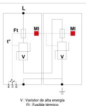
V : Varistor de alta energía Ft : Fusible térmico C : Contacto de teleseñalización t° : Sistema de desconexión térmica MI : Indicador de desconexión
