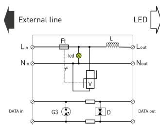
GSG : Descargador específico G : Descargador de gas 2-poles
