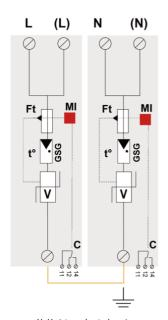
V : Varistance haute énergie GSG : Eclateur spécifique Ft : Fusible thermique C : Contact de télésignalisation t° : Système de déconnexion thermique MI : Indicateur de déconnexion
