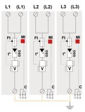
V: Varistor de alta energía GSG: Descargador specífico F1: Fusible térmico C: Contacto de téléseñalización t\*: Sistema de desconexión térmica MI: Indicador de desconexión
