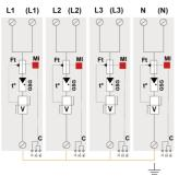
V : Varistor de alta energía GSG : Descargador specífico Ft : Fusible térmico C : Contacto de téléseñalización t° : Sistema de desconexión térmica MI : Indicador de desconexión
