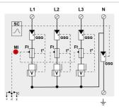
V : Varistor de alta energía GSG : Descargador specífico Ft : Fusible térmico C : Contacto de téléseñalización t° : Sistema de desconexión térmica MI : Indicador de desconexión
