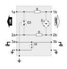
G : Eclateur à gaz tripolaire Gb : Eclateur à gaz bipolaire R : Résistance D : Réseau de diode d'écrêtage
