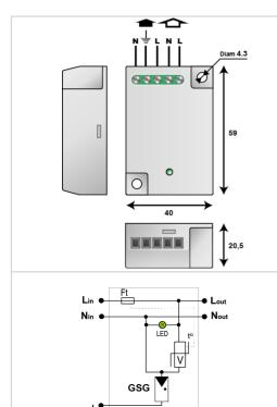
V : Varistance GSG : Eclateur spécifique LED : Indicateur de déconnexion Ft : Fusible thermique t° : Système de déconnexion thermique
