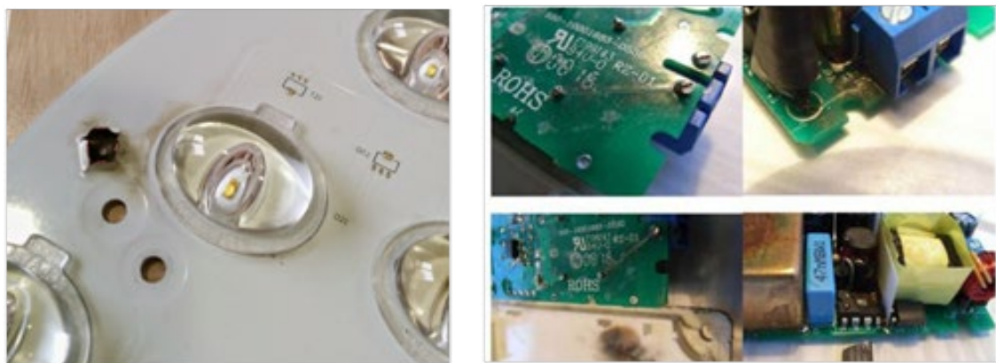
Exemples de destructions de plaque LED et drivers sur surtension transitoire «foudre»
