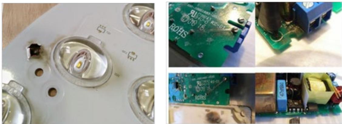
Ejemplos de destrucción placa de LED y conductores en sobretensión transitoria «rayo»
